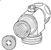
Instalace omezovače průtoku
